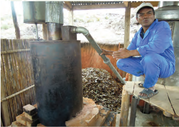
Alambic du centre rural pour la fabrication des huiles essentielles
